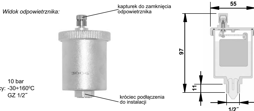
Rys. Przykładowe wymiary odpowietrznika (typ 250031) [mm].
